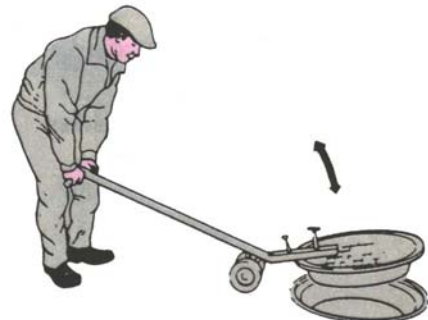
ภาพที่ 42 ใช้คานงัดเพื่อผ่อนแรง
