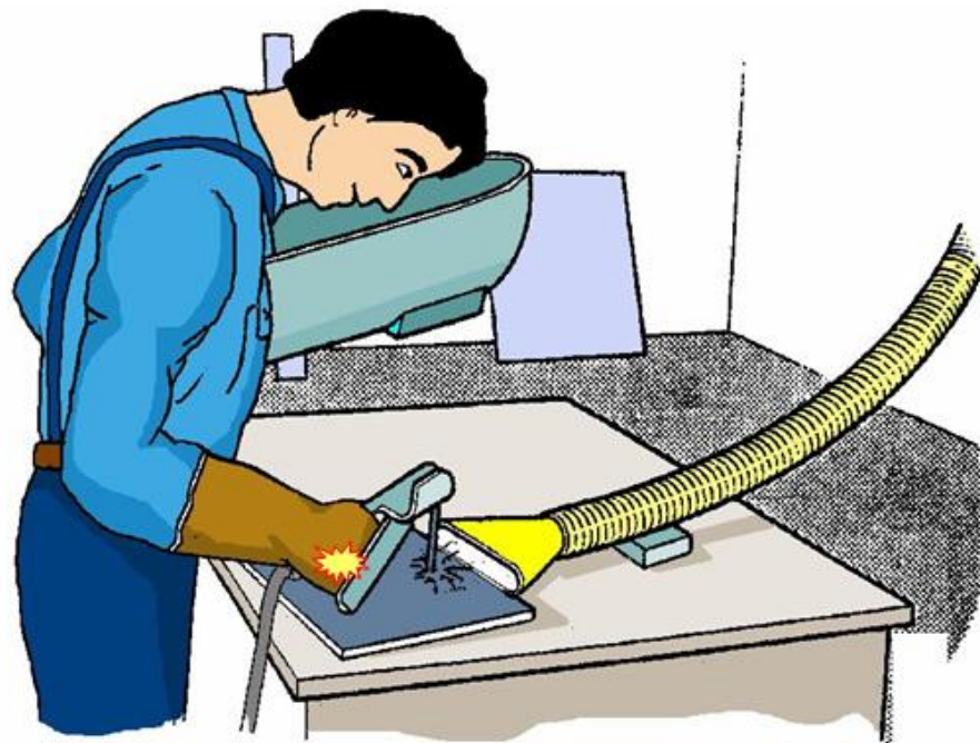
ท่อดูดอากาศแบบช่องเปิดยาว (slot extract) สำหรับการเชื่อมเป็นแนวยาว
